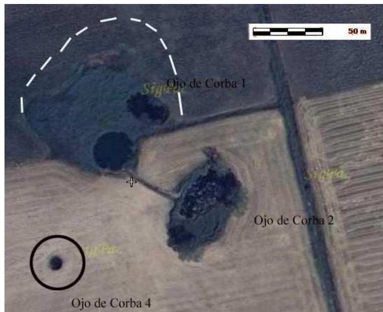
Figura 31.- Zona de Corba -1 que está sufriendo subsidencia o disminución de cota.
